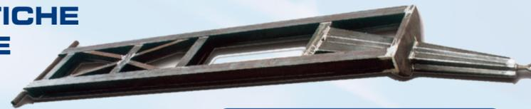
I nostri telai sono costruiti in acciaio Domex 700, i longheroni sono composti da piattebande superiore ed inferiore e da anima centrale da noi assemblati ed interamente saldati con filo speciale ad alta resistenza (sistema di costruzione industriale) con conseguente notevole resistenza ai sovraccarichi rispetto alle costruzioni classiche con uso di travi in HEA, HEB, od IPE in comunissimo FE.
