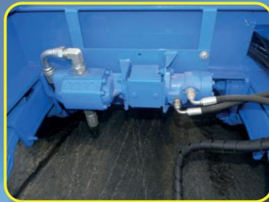
Pompa con motore idraulico
