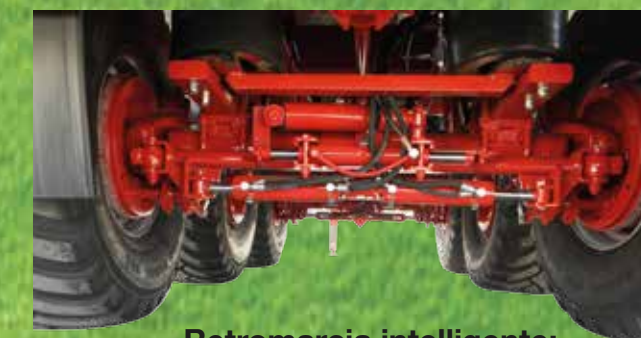
Retromarcia intelligente: Sistema retrosistem per la sterzata automatica ruote in retromarcia
