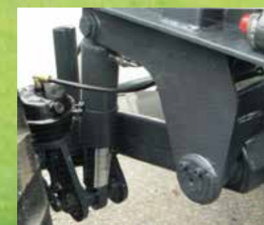
Sospensioni idropneumatiche con sistema di sollevamento 1° assale
